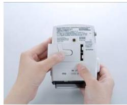
電池の上部を指で押さえつけたままカバーをスライドさせて、取り付けます
