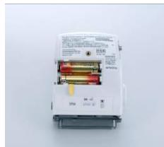
新しい電池の極性を確認し、黄色のリボンを下敷きに電池を入れます
